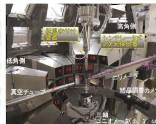
図1 14台の2次元検出器を装備した茨城県生命物質構造解析装置iBIX
