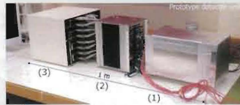
(1) 256ch x 256ch 波長変換ファイバ読み出し方式 高分解能中性子イメージング検出器 (2) 高速アンプ&ディスクリミネータ (3) 信号処理モジュール(FPGA)
