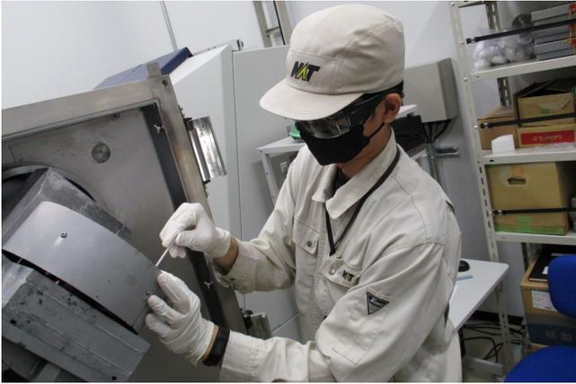
写真3 中性子ミラー成膜作業
