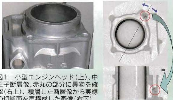
図1 小型エンジンヘッド(上)、中性子断層像、赤丸の部分に異物を確認(右上)、積層した断層像から実際の切断面を再構成した画像(右下)
