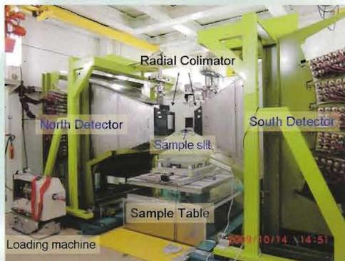
図1 工学材料回折装置「匠」
