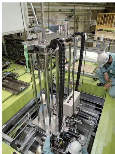
図1 改良したiMATERIAの試料交換搬送機構
