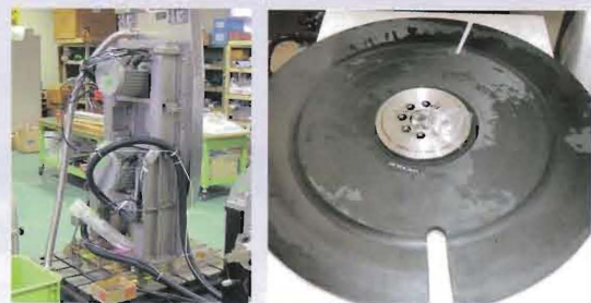
図3 (左)高速ディスクチョッパー(2台、タンデム型)と(右)そのディスク
