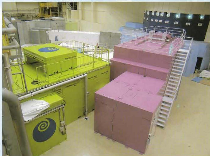
材料構造解析装置(iMATERIA)の設置状況 (黄緑の構造物が遮蔽BOX、右隣は全散乱装置(NOVA))
