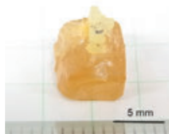
図2 高圧酸素下で育成した高品質BKT-BNT単結晶
